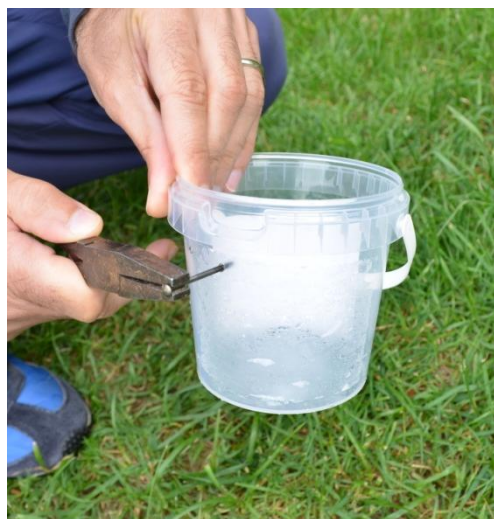
Foto 7b. Effettuare dei fori con chiodi ( \varnothing 2mm) incandescenti distanti c.a 2 cm.
